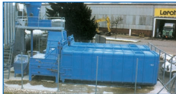
Druckereientsorgung, 2 Kurzbaupressen, Typ ST-SEL-TS
